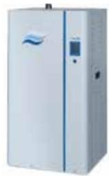
燃气式加湿设备近几年在欧洲越来越多被使用，其主要原因是这种设备相对于电极和电热加湿设备更加环保、安全、高效。Condair GS 燃气式加湿设备由 Condair 加拿大工厂生产。单机最大加湿量可达 240kg/h，可以 10 台联机达到 2400kg/h。GS 具备图形显示功能，可以设置水箱清洁程序和自我诊断能力。GS 机箱具备保温特性，可以室外安装，确保安全。
